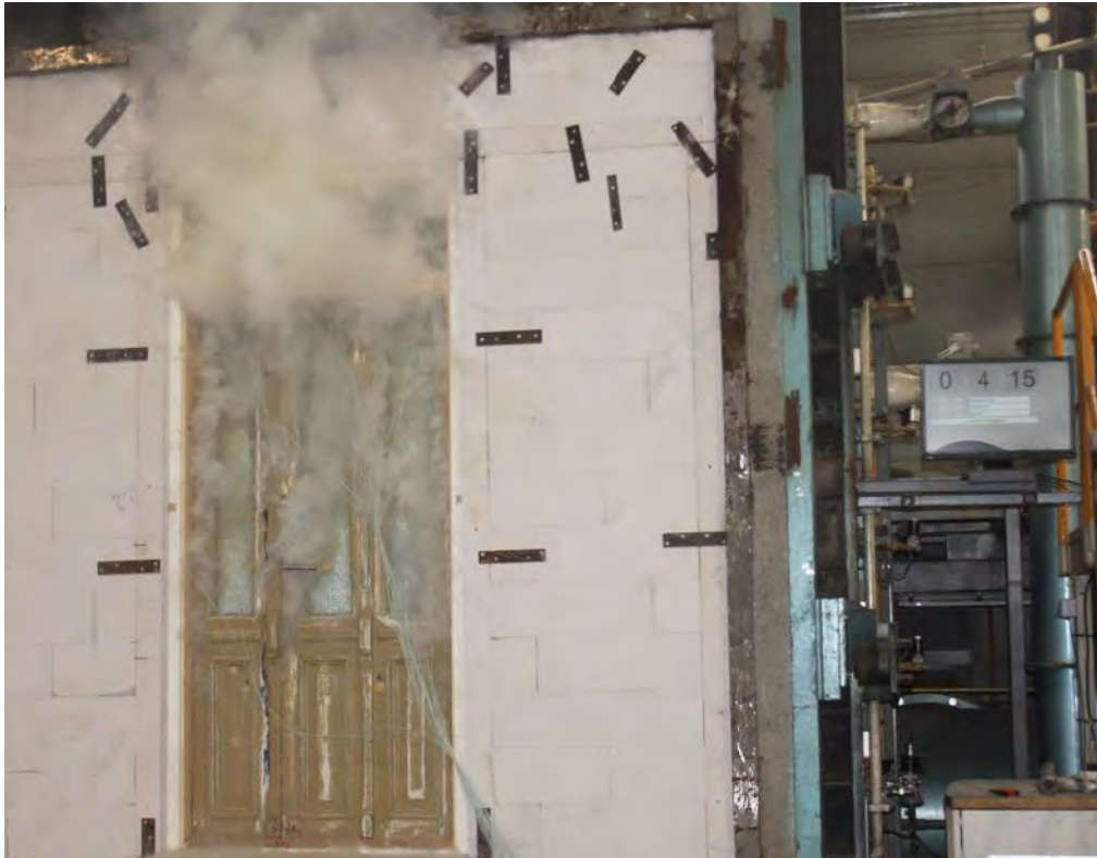
Foto 7: Ueksponert side av dørkonstruksjonen etter 4 minutter og 15 sekunders testtid.
