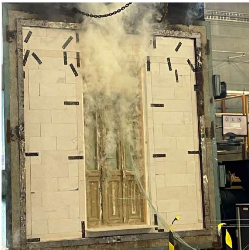
Figur 10 Etter 4 min 15 sek kommer det fremdeles mye røyk gjennom døren. Det var forventet at de ekspanderende tettelistene på dette tidspunktet skulle ha blitt aktivert og fungert bedre som røyktetting. Foto: NIKU
