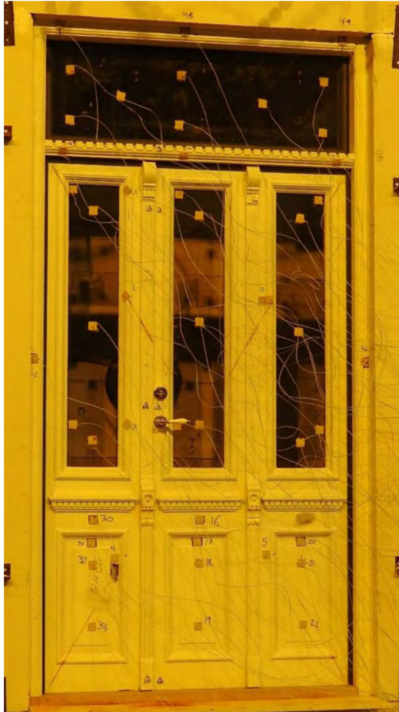
Figur: 1 Bilde av døren som ble branntestet i 2019 og som har vært utgangspunkt for vurdering av nødvendige tiltak.
