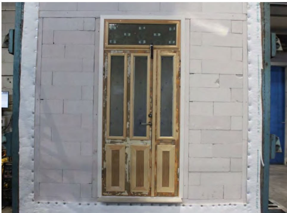
Foto 6: Eksponert side av dørkonstruksjonen før test.
