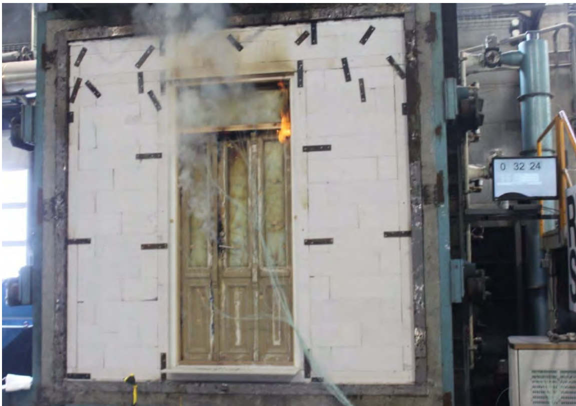
Foto 10: Ueksponert side av dørkonstruksjonen etter 32 minutter og 24 sekunders testtid.
