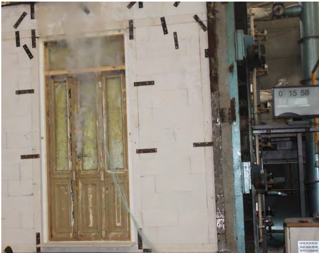
Foto 8: Ueksponert side av dørkonstruksjonen etter 15 minutter og 58 sekunders testtid.
