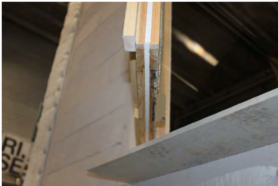
Foto 3: Bilde viser underkanten av dørblad med innfelt volumøkende list.
