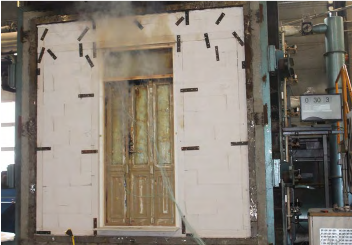
Foto 9: Ueksponert side av dørkonstruksjonen etter 30 minutter og 3 sekunders testtid.
